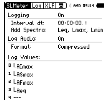
XL2 logging setup for DM 16 marzo 1998
